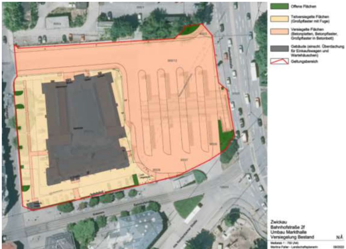
Abb.: Kartierung der Versiegelungsarten, September 2022 | o. M.
